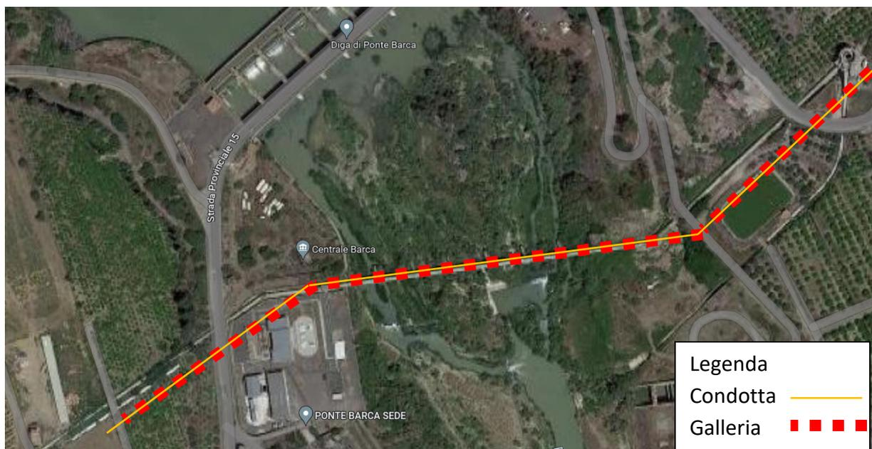
**Figura 13 – aerofotogrammetria con tracciato della galleria contenente la condotta**
