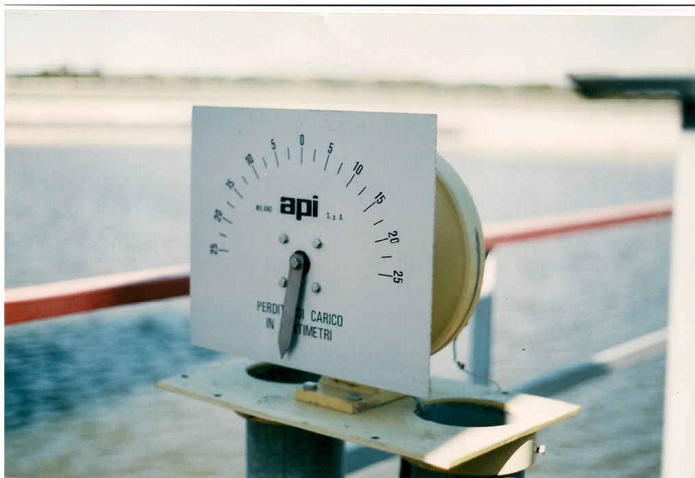
FOTO 18 : Particolare 1 sensore perdita di carico
