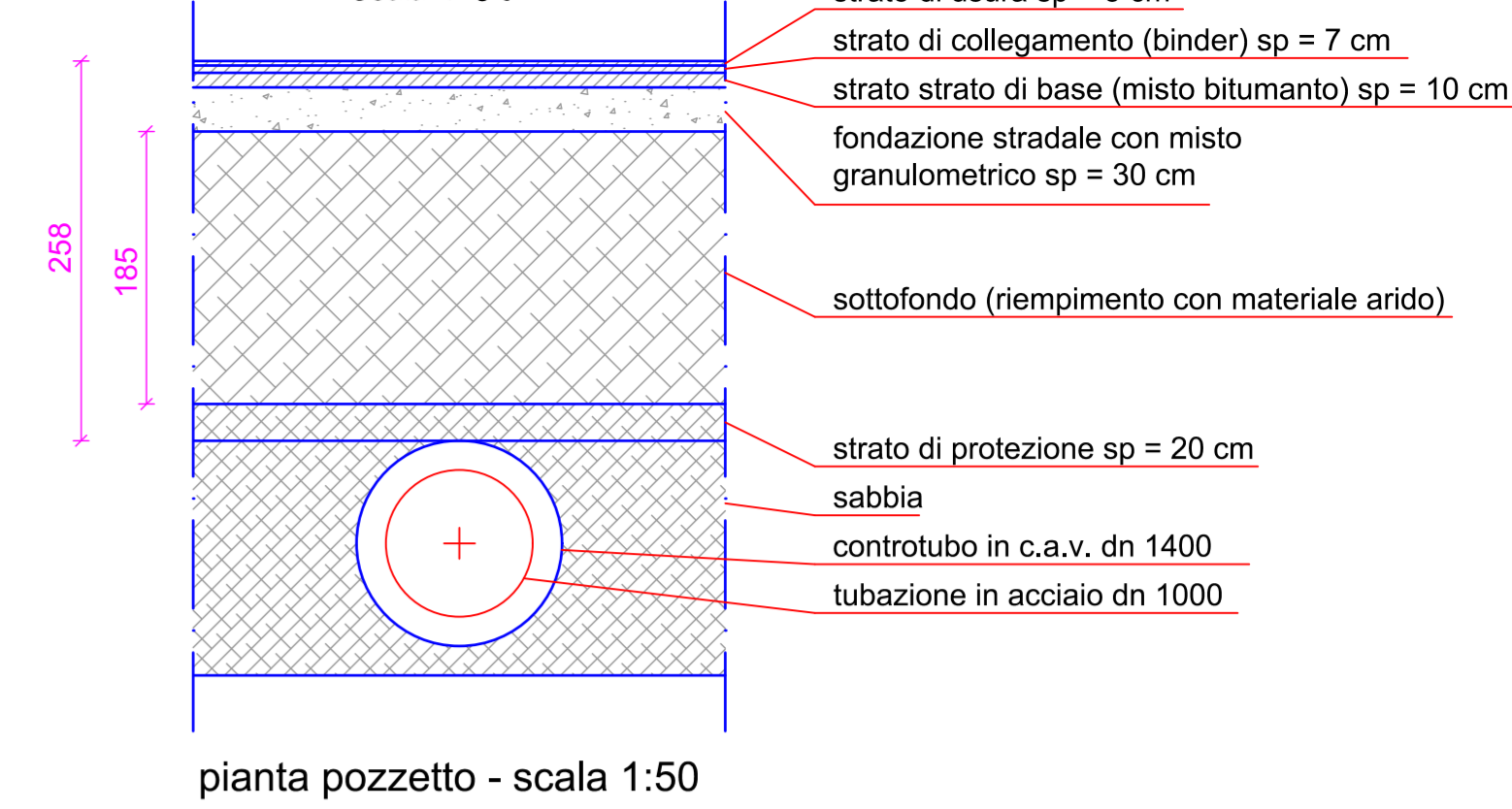
attraversamento sotto strada scala 1:50
