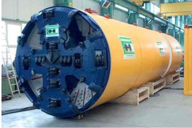
Esempio di testa di scavo per terreni misti (da Herrenknecht website)
