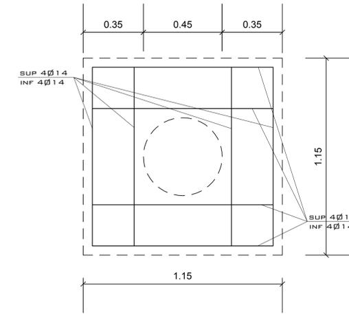
POZZETTO PER IDRANTE CON GRUPPO AUTOMATIZZATO DI MISURA E CONSEGNA SEZIONE D-D
