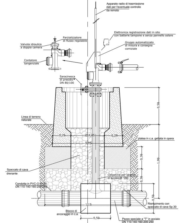
POZZETTO PER IDRANTE CON GRUPPO AUTOMATIZZATO DI MISURA E CONSEGNA "TERMINALE"
