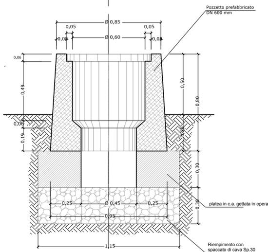
POZZETTO PER IDRANTE CON GRUPPO AUTOMATIZZATO DI MISURA E CONSEGNA "DI LINEA"
