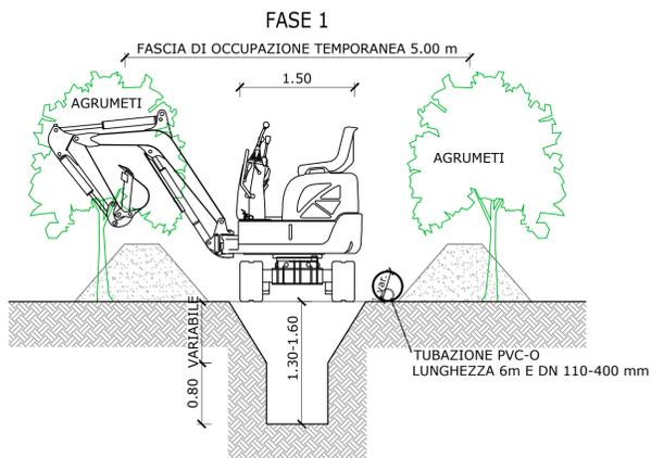
PIANTA DI SCAVO E POSA TUBAZIONE
