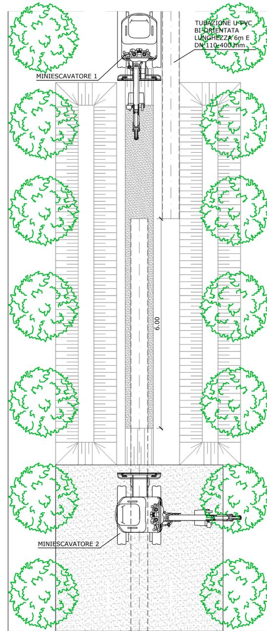
SEZIONE DI SCAVO CON POSA TUBAZIONE
