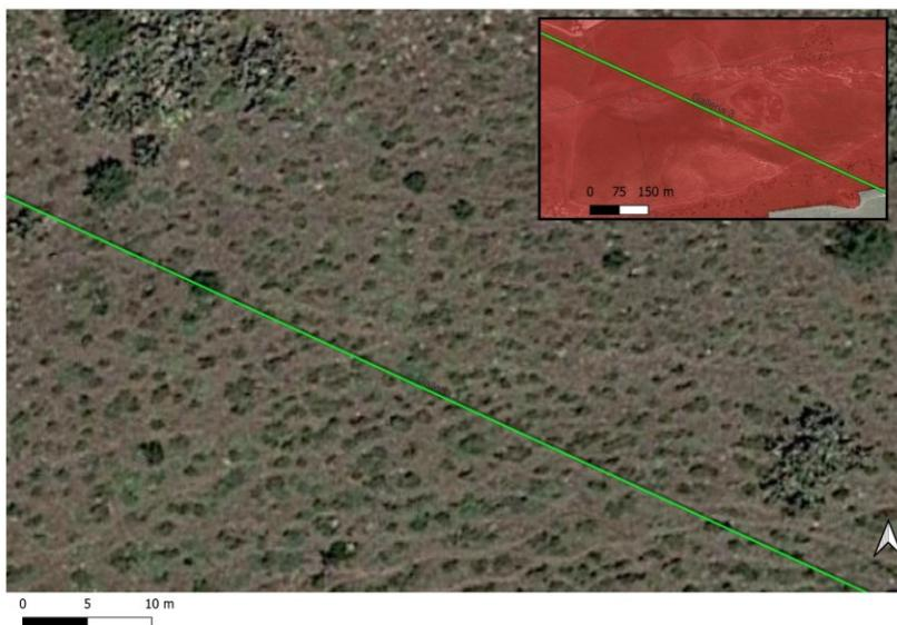
Figura 7 Controllo del tracciato da foto per verificare che il canale risulti completamente interrato, dalle foto aeree/satellitari sopra citate non si evincono anomalie o particolari necessità di lavori in superficie, come pozzi di ispezione..
